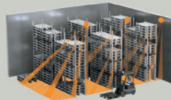
IS 345 MX Highbay Rechteckiger Erfassungsbereich für Hochregale, bis zu 14 m Montagehöhe
